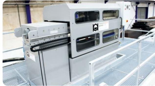
Membranfilterpresse für Prozesswasseraufbereitung im Betonwerk
