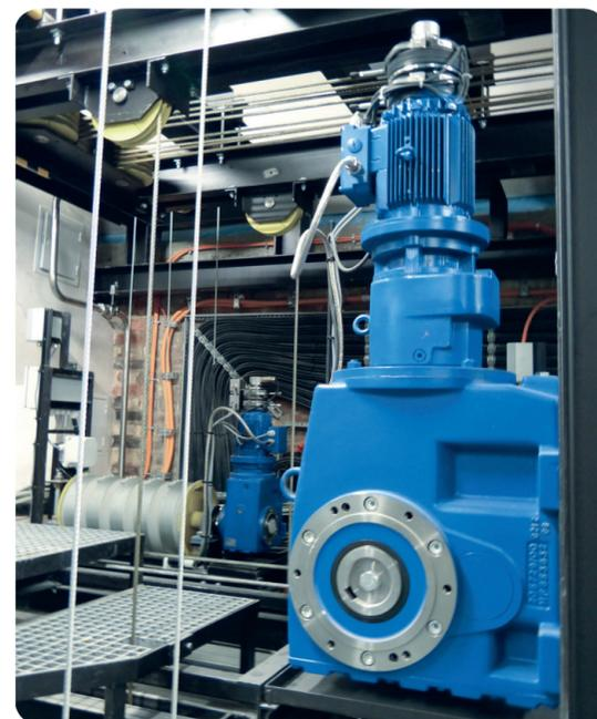
Die Getriebegehäuse aus Grauguss sind stabil, schwingungsdämpfend und für Dauerbetrieb konstruiert. Ölverlust oder Eindringen von Staub wird durch Radial-Wellendichtringe mit Staublippe verhindert. Sämtliche Zahnräder werden gefräst, ballig geschabt oder geschliffen und oberflächengehärtet. Durch Schrägverzahnung der Zahnräder wird höchste Laufruhe erreicht. Die maximalzulässige Radial- und Axialkräfte sind zu beachten.
