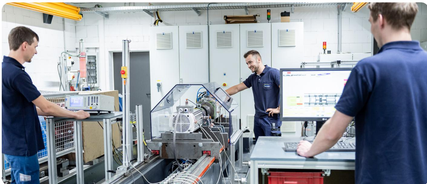
Neben den HIMMEL®-Getriebemotoren sind wir auch in der Lage, die HIMMEL®-Trommelmotoren auf unseren Belastungsprüfständen ausgiebig zu prüfen.
