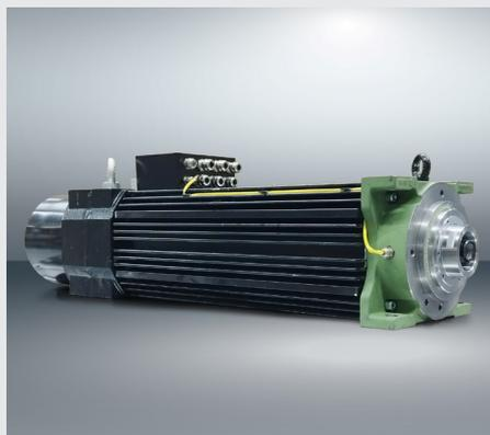
Instandsetzung eines HSK80-E Spindel-motors (63 kW, 12.000 U/min)
