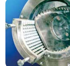
Mögliche Anpassung von Rotor und Stator
