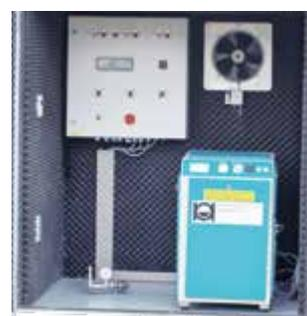
Ausführung mit Schraubenkompressor und integrierter Pumpensteuerung
