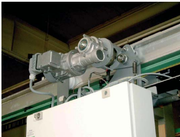
Bild 3: EHB-Fahrwerk mit angeflanschem Motor und angebautem Steuergehäuse.
