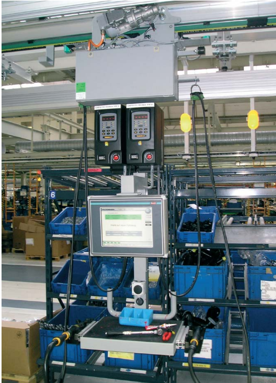
Bild 6: Beispielhafter Aufbau eines EHB-L-Gehänges bei einer Anwendung in der Automobilindustrie
