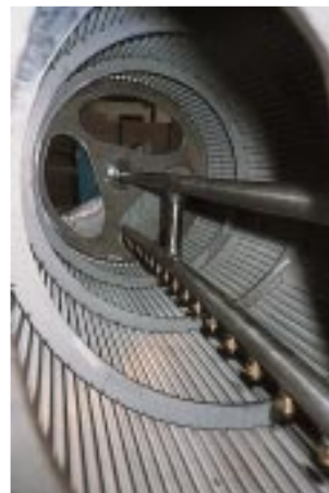
Innenliegende Düsenleiste zur Reinigung des HTG-Trommelsiebes
