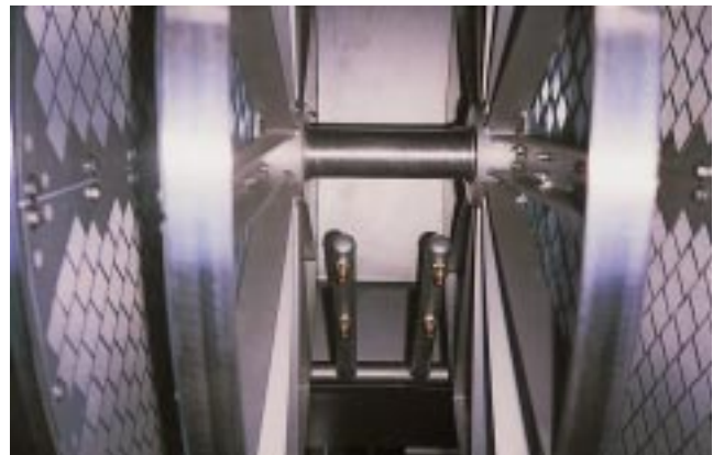
Düsenlanzen zur Reinigung des HTG-Drehfeinsiebes
