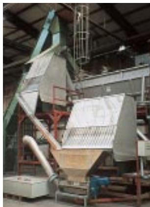
Zwei HTG-Schrägsiebe im industriellen Einsatz
